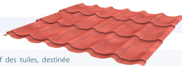
La tuile 24-183-1100 est une plaque emboutie au motif des tuiles, destinée aux couvertures sèches et surcouvertures de pente courante 25% à 50%. Elle est une alternative aux tuiles classiques pour les nouvelles constructions, mais peut aussi servir pour la rénovation de vieilles toitures. La laque définie à la commande de JI 24-183-1100 Panneau-tuile est appliquée en face SO. Nous consulter à la commande pour connaissance de la méthode de calepinage.
