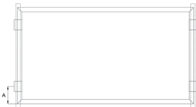
Figure 8 : Montage avec étriers sur le petit côté, rail perpendiculaire au grand côté.
