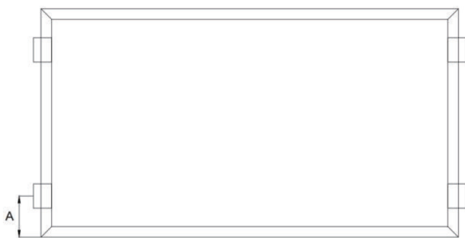
Figure 7 : Montage avec étriers sur le petit côté – Sans rail
