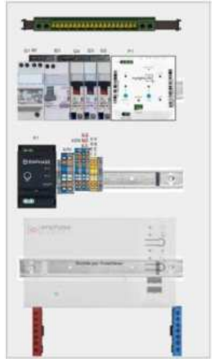
Figure 5. Cas d'utilisation typique et mise en armoire UCG-E4301-11-FR
