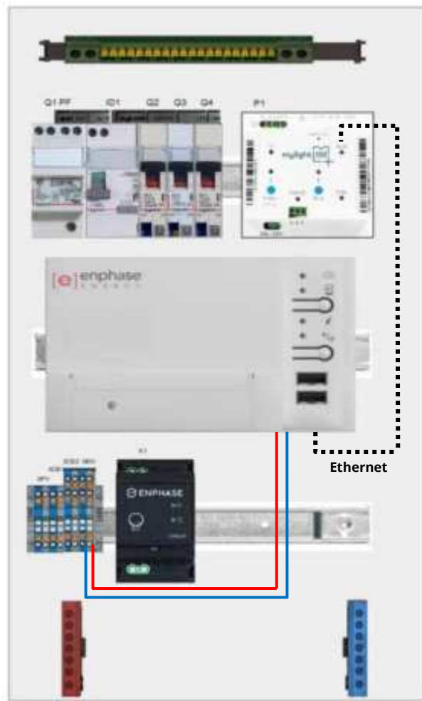
Figure 31. Schéma de principe de montage de la passerelle Envoy
