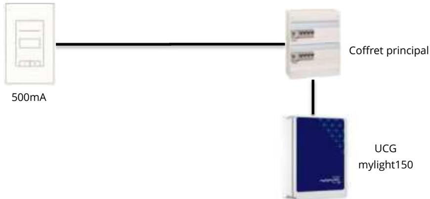
**Figure 3. Schéma de raccordement de l'UCG mylight150**
