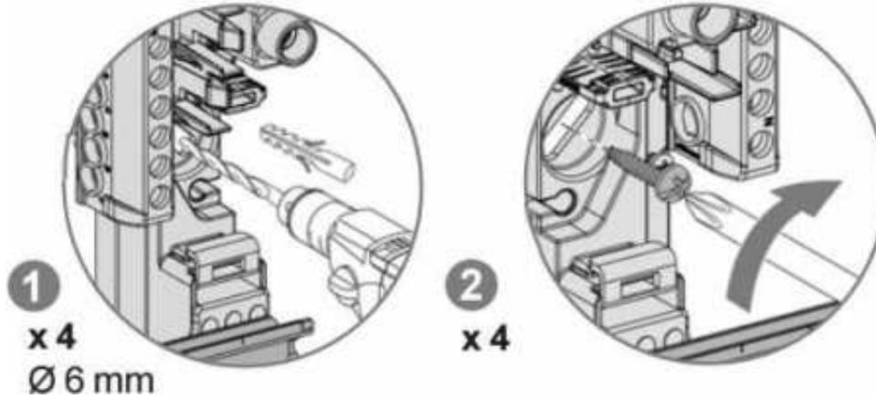
Figure 2. Montage de l'UCG sur un mur
