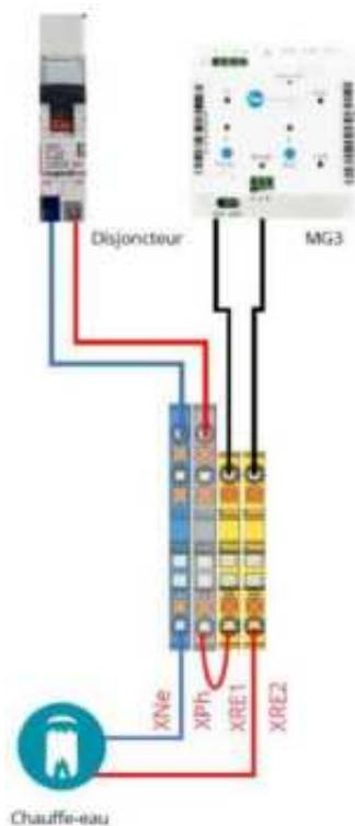
Figure 6. Schéma de pilotage d'un chauffe-eau électrique monophasé
