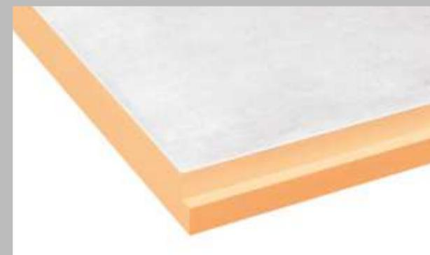
**SOPRAXPS PROTECT C** est un complexe associant un panneau isolant XPS à un enduit ciment de parement de 3 mm. Dans le cas d'une toiture-terrasse inversée, les panneaux **SOPRAXPS PROTECT C** sont mis en œuvre sur l'étanchéité du relevé. Ils sont ensuite maintenus en tête avec des pattes de fixation.
