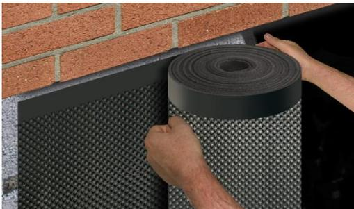
FONDALINE® peut être appliqué horizontalement ou verticalement en fonction de la profondeur du bâtiment. Des chevauchements de 20 cm sont nécessaires. Ajouter BITULINE® ou un revêtement protecteur et imperméabilisant comme ONDUPRIMER® sur la maçonnerie.
