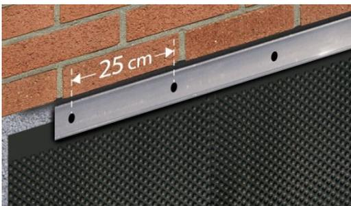
FONDALINE® peut être cloué directement sur le béton uniquement sur des niveaux où il n'y a pas de risque d'infiltration, d'humidité ou de nappe phréatique.
