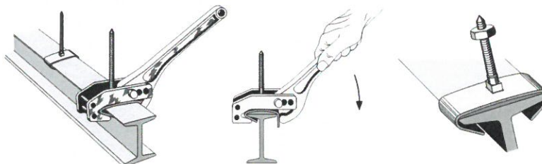
Figure 1 - Exemple de mise en oeuvre du boulon Japy avec agrafe sur support IPN
