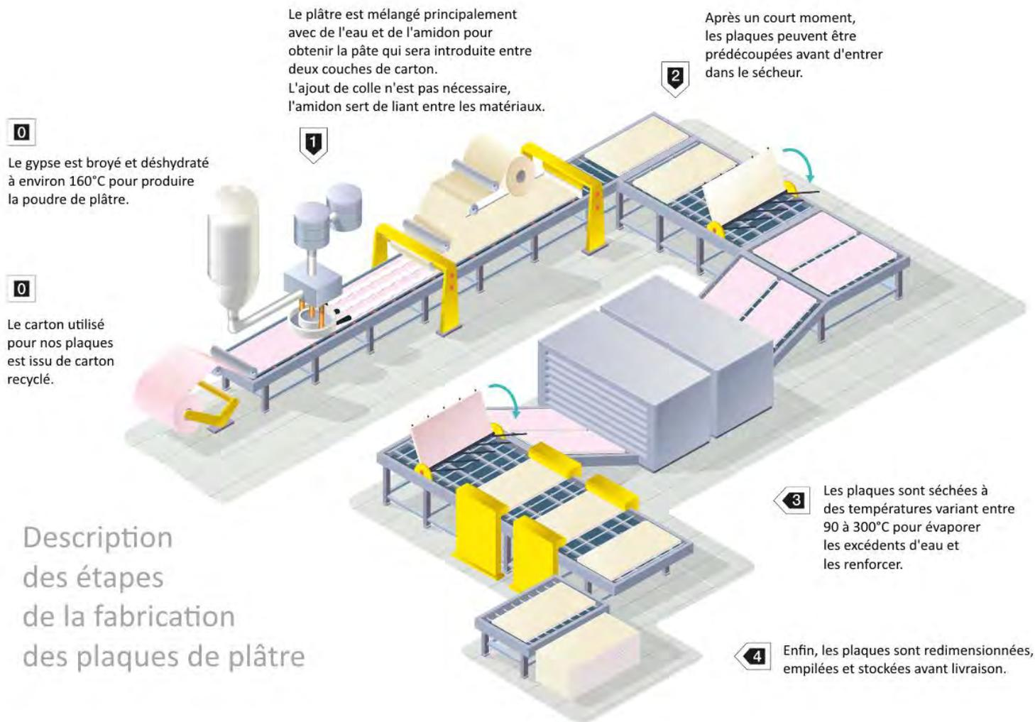
Description des étapes de la fabrication des plaques de plâtre
