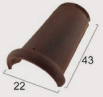
31 XLM Faîtière ronde ventilée à emboîtement (section ventilation 10 cm 2 ) / 2,5 au ml / 4 kg
