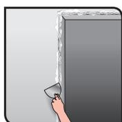
2. Fixer le protège angle perforé dans l'enduit avec des vis à ses extrémités.
