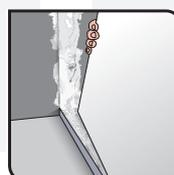
5. Réaliser le joint entre le U plastique et la plaque de plâtre.
