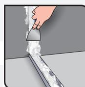
4. Apposer la bande à joint et enduire et insérer la plaque de plâtre dans le U plastique.
