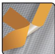
L'étanchéité à l'air à ce niveau est assuré par le collage du ruban adhésif universel centré sur le chevauchement. Les lés de pare vapeur doivent être suffisamment tendus et ne pas présenter de plis
