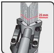
2. Positionner l'agrafeur et frapper au marteau sur l'embout nylon.
