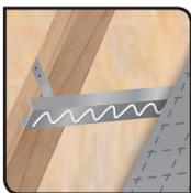
1. Poser le pare vapeur tendu entre les éléments d'ossature :
