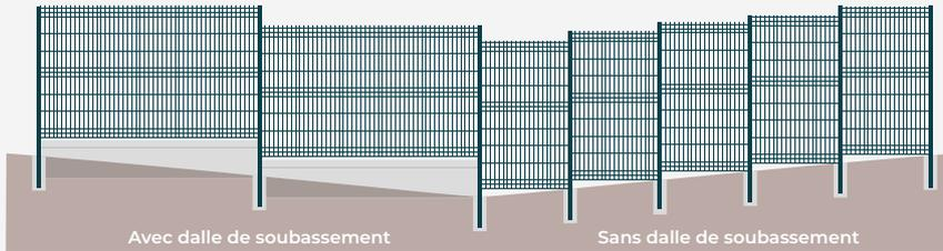
Adaptation optimale à la pente grâce au système de fixation à brides du poteau
