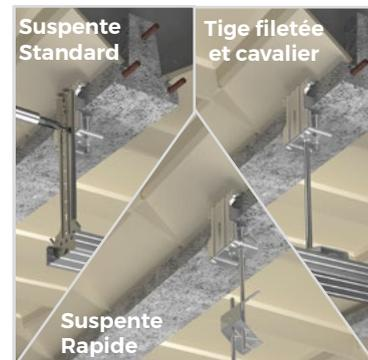
3. Fixer votre suspente dans la fente du grip à l'aide de 2 vis autoforeuses **ou** visser la tige filetée de 6 mm de diamètre dans le trou taraudé **ou** insérer votre suspente rapide dans le trou du grip prévu à cet effet.
