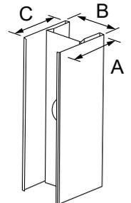
**(1)** montant ID<sup>4</sup> éclissé : 2 barres de 1500 mm éclissées - plage d'utilisation : 1500 à 2700 mm - palette de 2 m
