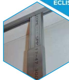
\*Hauteur maximum de la cloison : 3,05 m (sol fini) avec deux lignes d'appuis. Pour les hauteurs de cloison inférieures à 2,70 m (sol fini) prévoir une seule ligne d'appui à 1,35 m.
