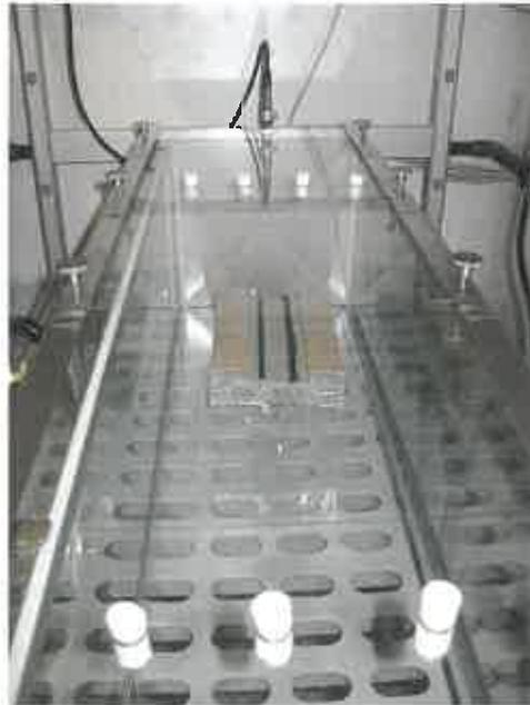
**Photo 5 : Eprouvette conditionnée dans la chambre d'essai d'émission**
