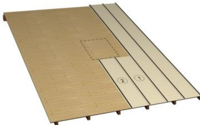
Figure 27.c – Mise en place de la 2ème lame sous costière
