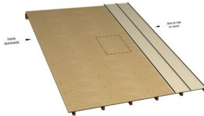
Figure 27.a – Mise en place des lames adjacentes
