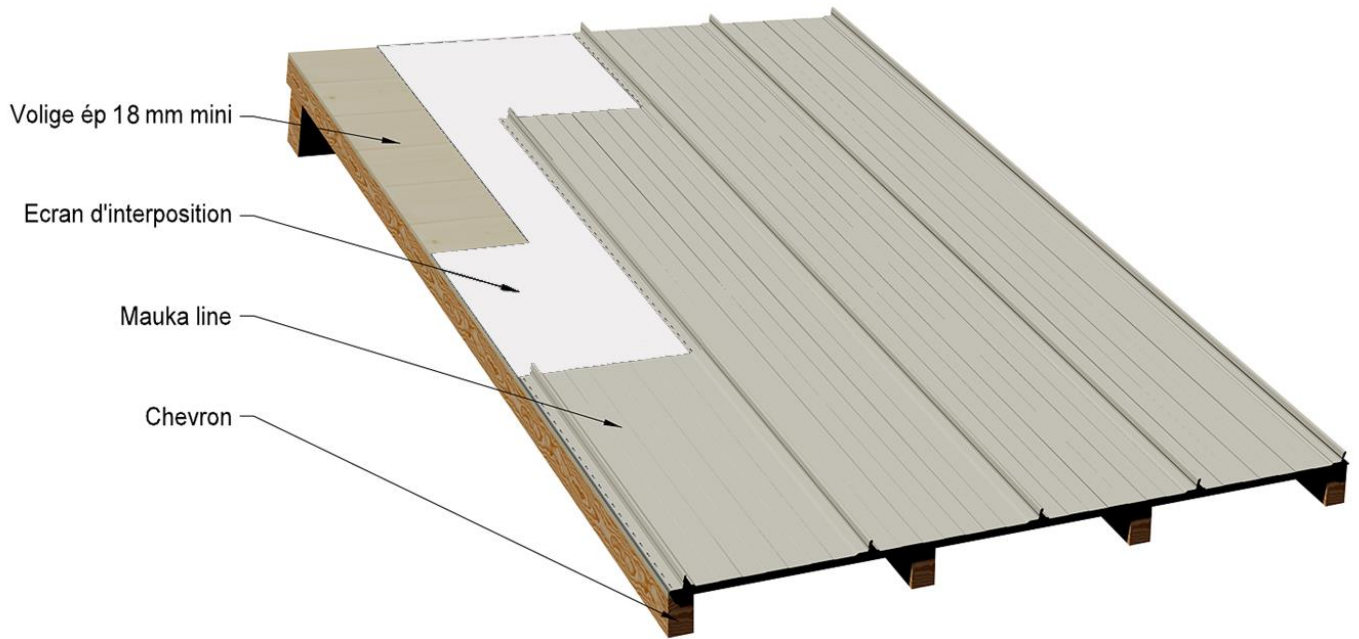
Figure 14b – Pose sur volige et panneaux à base de bois avec écran d'interposition
