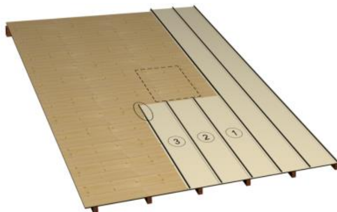
Figure 27.d – Mise en place de la 3ème lame après sa découpe
