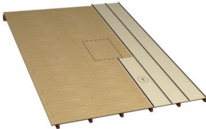
Figure 27.c – Mise en place de la 2ème lame sous costière
