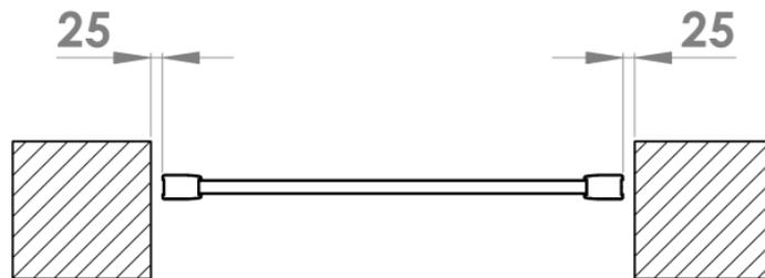
Le jeu de 25mm est prévu pour éviter les coincements de doigt entre le pilier et le montant du portillon côté gond lors de l'ouverture du portail. Un montage avec un jeu inférieur à 25mm n'est pas recommandé et la responsabilité du fabricant ne pourra être engagée en cas d'accident. Un joint est fourni afin de cacher ce jeu de fonctionnement,
