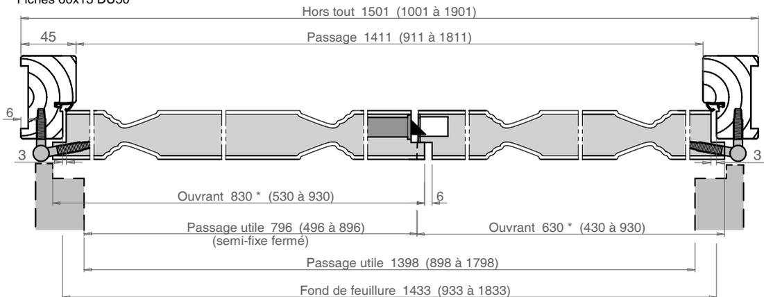
\* largeur ouvrant et semi-fixe fabriqués = largeur théorique - 3 mm
