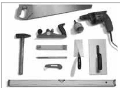
Figure 2 : Outillage de façonnage traditionnel en construction sèche
