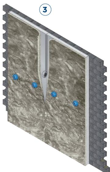
Au-delà d'une hauteur de 2,70 m, superposer les plaques Utherm Wall L Comfort/Utterm Wall L et disposer les fixations tous les 1,35 m. Pour de grandes hauteurs, prévoir une reprise de charge tous les 4 m.
