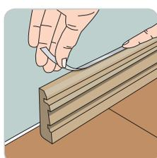
**ÉTAPE 3 :** Appliquez une **bande de protection Hydro+ Strip** à la base de la plinthe à l'aide d'une bande adhésive. Cette bande protège votre plinthe de l'humidité, tout en permettant au sol stratifié de se dilater/rétracter.
