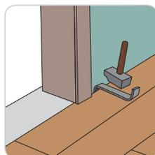
Les côtés longs des lames intègrent le système DuoLoc. Cela signifie que les lames peuvent s'emboîter sur le côté long à l'aide d'un tire-lame, dans les situations difficiles où il n'est pas possible de soulever la lame dans le but de la fixer sur le côté long.
