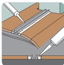
Avec les profils de sol, utilisez un scellant par-dessus le fillertwine avant d'installer le profil, afin d'éviter au côté et à la base du sol stratifié tout contact avec l'eau.
