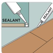
**ÉTAPE 2 :** Comblez l'écart de dilatation avec le **scellant Hydro+ Sealant**. Le mastic doit toucher le mur et le sol stratifié de telle manière que lorsqu'il est appliqué, il comble complètement le joint.
