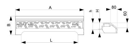
Groupe 3: dispositifs de couronnement installés dans la zone des caniveaux ou bordures longeant les voies de circulation et les trottoirs qui, mesurée à partir de la bordure, s'étend au maximum à 0,5m côté voie de circulation , et au maximum à 0,2m côté zone piétonne.
