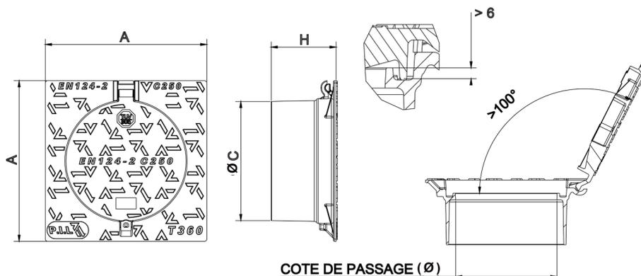
1 Groupe 3 : dispositifs de couronnement installés dans la zone des caniveaux ou bordures longeant les voies de circulation et les trottoirs qui, mesurée à partir de la bordure, s'étend au maximum à 0,5m côté voie de circulation, et au maximum à 0,2m côté zone piétonne.
