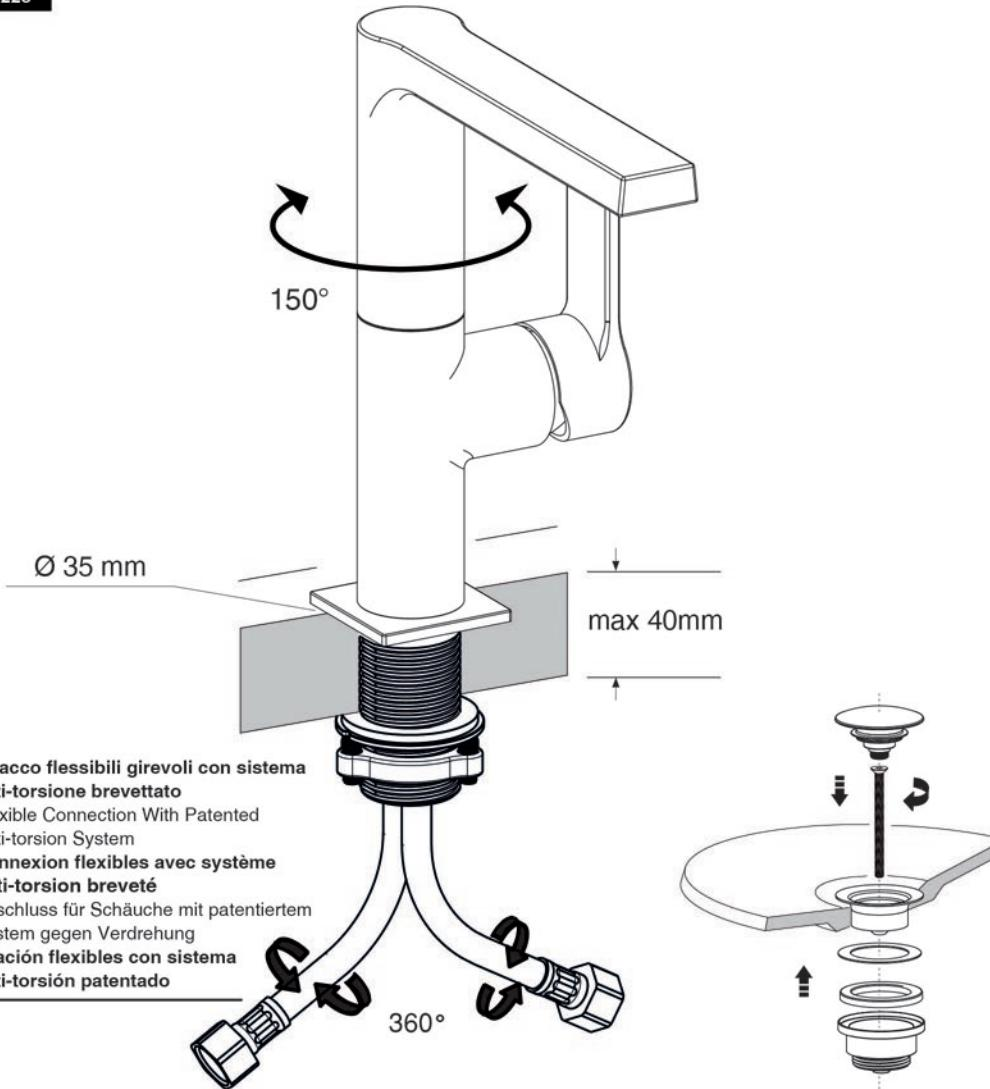
Montaggio e Pezzi di Ricambio - Installation And Spare Parts - Montage et pièces détachées
