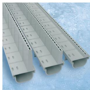
La grille à fente PVC peut être installée à colle ou à vis sur les caniveaux à grilles 100 et 130 "PRATIKO", en conservant la modularité de 50 cm avec des sous-multiples prédécoupés de 10 cm; le produit permet l'évacuation et la collecte de l'eau dans les espaces publics et privés, assurant une résistance élevée à la charge et un effet esthétique agréable.
