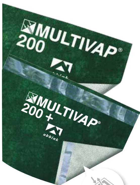
Insensibles aux agressions telles que chaleur, UV et traitements du bois de charpente, les MULTIVAP® 200/ MULTIVAP® 200+ sont Hautement Perméables à la Vapeur d'eau. Ils conviennent à tous les types de pose : ventilés en sous-face ou non, sur chevrons, voliges, ou Sarking, avec des entraxes entre chevrons de 60 cm. Ils se posent fermés au faitage. Ils permettent le marquage au cordeau et résistent à l'ammoniac.
