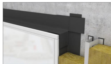
Étanchéité pourtour de fenêtre
