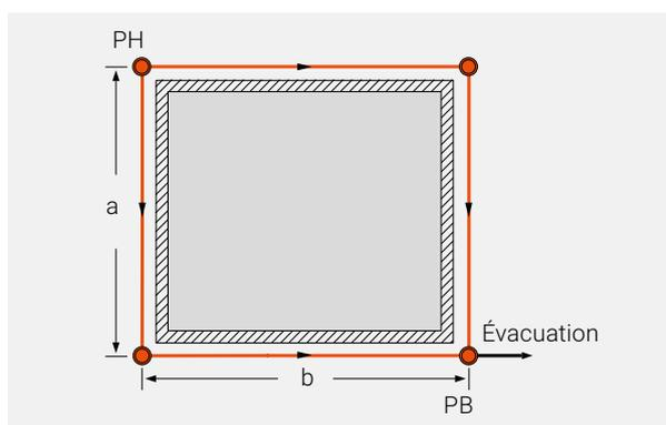
Mesurer la longueur des tubes  $a + b$  du point haut (PH) au point bas (PB).
